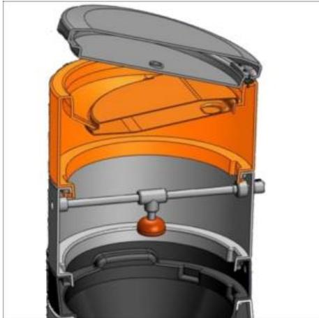
Для продуктов с низкой растворимостью рекомендуется установка **DDS-MA PLUS**. Распылительная головка установлена сверху, чтобы увеличить контакт с поверхностью и, следовательно, улучшить разбавление продукта.
